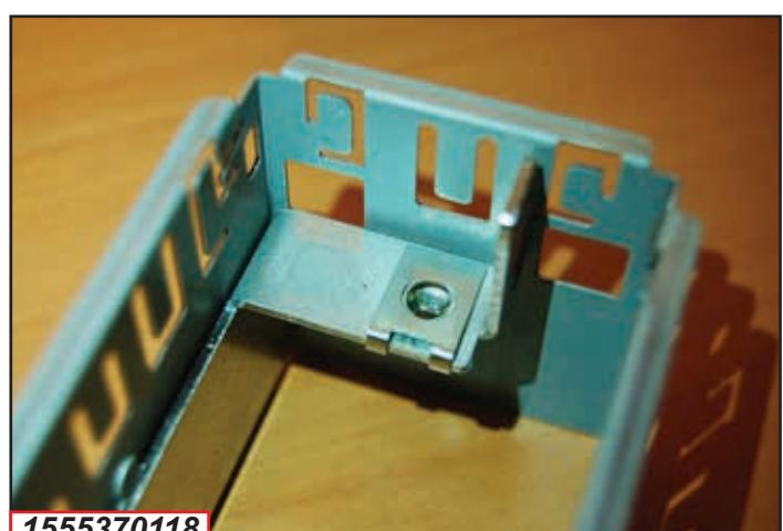
**NL** Schuif het inbouwraam in het DIN-slot.
