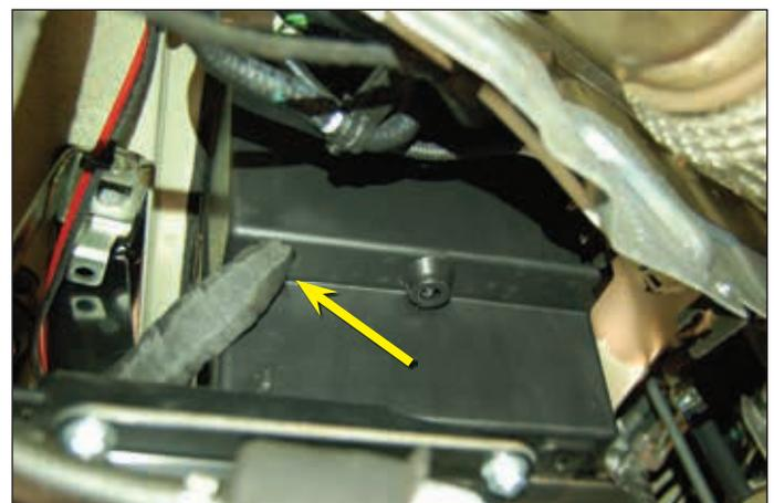
7. Ziehen Sie das Kabel vorsichtig in das Batteriegehäuse.
