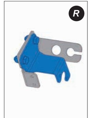
17. Bringen Sie die Höhensensorstütze an der oberen Balgstütze an (6x2: nur für Achse 2).
