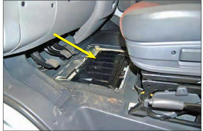
2. Lösen Sie die gekennzeichneten Schrauben. Nehmen Sie sie nicht heraus.
