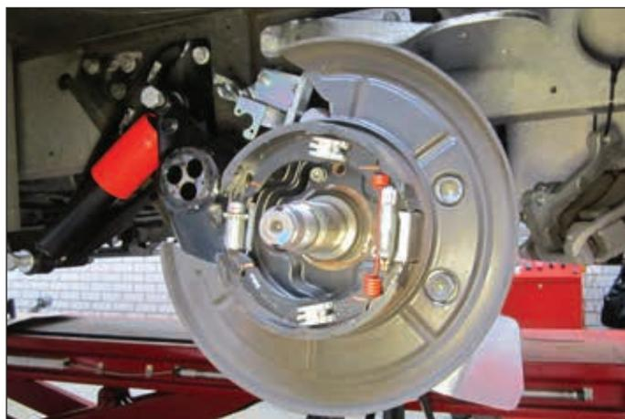
29. Montieren Sie das Radlager<sup>1</sup>.
